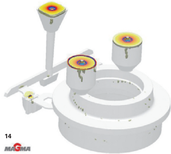
Fig. 13 Presenza di hot spot all'interno del getto. Si può notare in questo caso la formazione di punti caldi negli archi di circonferenza compresi tra un raffreddatore e l'altro.
