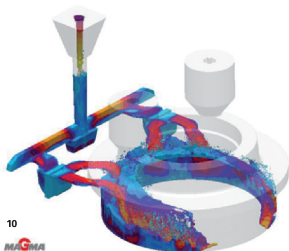
Fig. 10 Andamento delle velocità del metallo a metà del riempimento.
