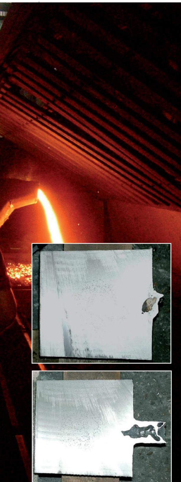
**Fig. 6** Sezione delle maniche poste a confronto: prova 3, fornitori A e B.
